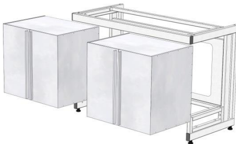
Рис. 1. Установка высоких тумб на каркас
